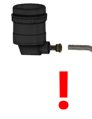
Рис. 12. Монтаж винта воздухоотводчика
