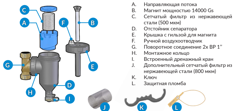
Рис. 1. Конструкция магнитного сепаратора шлама ADS 160
