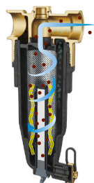
Рис. 1. Притяжение загрязнений магнитом
