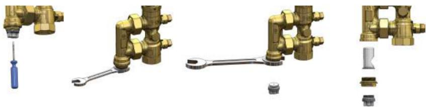
Рис. 14. Схема технического обслуживания AHS 500
