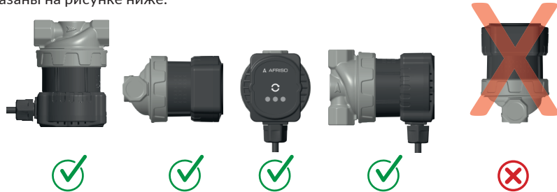
Рис. 2. Допустимые монтажные положения насоса APW
