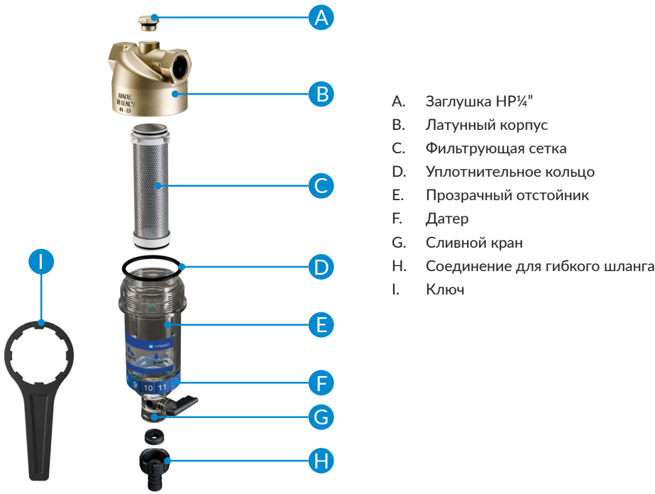
Рис. 2. Конструкция фильтра для воды AWF
