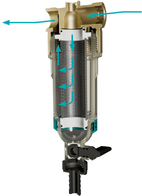
Рис. 1. Схема прохождения воды через фильтр AWF
