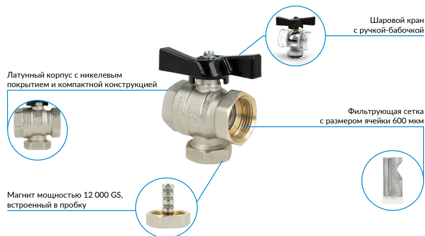
Рис. 2. Конструкция шарового крана BFV
