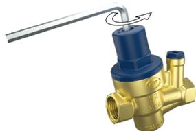
3. С помощью разводного ключа или гаечного ключа 29 мм открутите и снимите синюю крышку, чтобы получить доступ к пружине и пластиковому кольцу.
