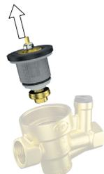
5. Осторожно снимите уплотнительное кольцо и фильтрующую сетку с внутреннего вкладыша. Очистите фильтрующую сетку от загрязнений, промыв ее под проточной водой. Если сетка повреждена, ее следует заменить.
