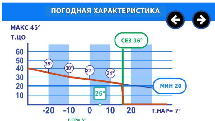
Рисунок 20. Предопределенная погодная характеристика для напольного контура
