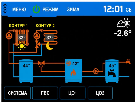
Рисунок 5. Пример схемы работы системы "переключающий клапан"
