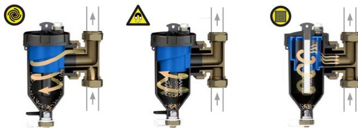
Рисунок 9: Этапы фильтрации теплоносителя в сепараторе ADS 160
