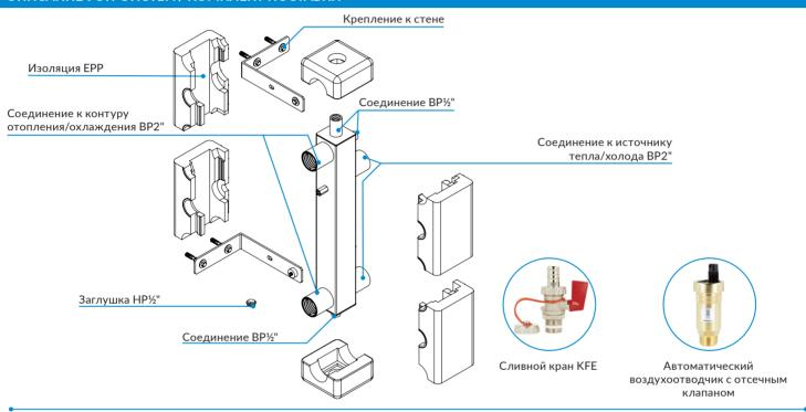
Гидравлическую стрелку KSV 160 HW следует подключать к контурам отопления/охлаждения в соответствии с маркировкой на присоединениях: красный = подающая линия, синий = обратная линия из системы/к источнику тепла или холода.
