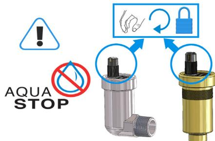
Применение отсечного клапана позволяет заменить воздухоотводчик без необходимости слива теплоносителя из системы. В случае некорректной работы следует выкрутить воздухоотводчик из системы. Затем открыть корпус и промыть механизм чистой водой с добавлением мощного средства.
