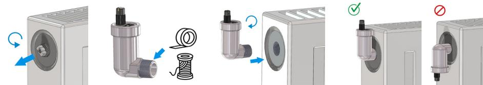
Рис. 2. Монтаж углового воздухоотводчика
