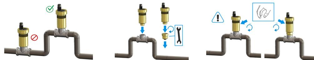
Рис. 1. Монтаж вертикального воздухоотводчика
