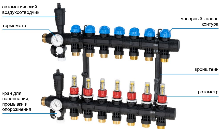
Рисунок 2: Конструкция коллектора ProCalida EF1
