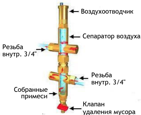
Потоковый фильтр с сепаратором воздуха
