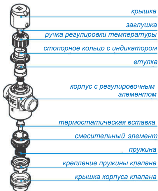
Рис. 2: Конструкция клапана ATM Kvs = 3,2 м³/ч и 4,2 м³/ч
