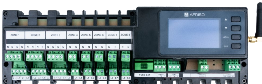
Рисунок 1: Конструкция беспроводного контроллера WB02 F-8-230 – вид без корпуса
