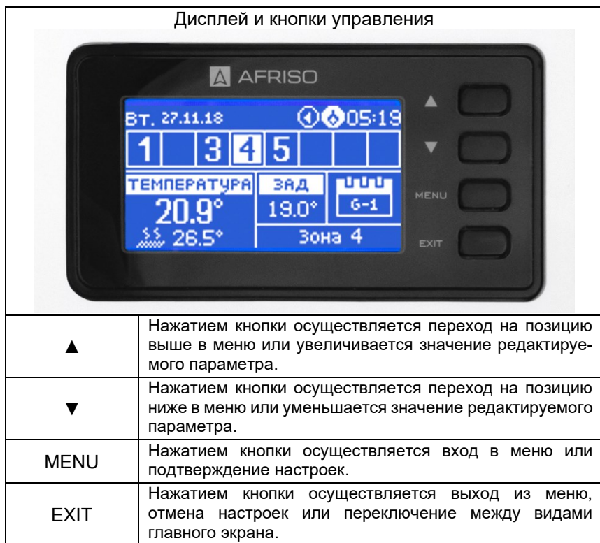
Рисунок 2: Описание кнопок беспроводного контроллера WB02 F-8-230
