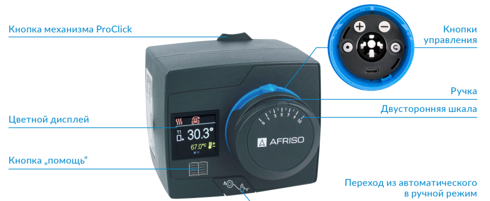
Рис. 1. Конструкция привод-контроллера постоянной температуры ACT ProClick
