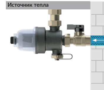
Рис. 3. Монтаж сепаратора ADS 110 на вертикальном трубопроводе
