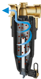
Рис. 2. Оседание примесей на сетчатом фильтре
