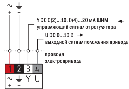
Рис. 11. Схема электрических подключений
