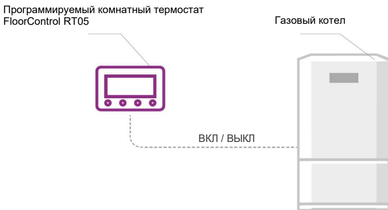
Рисунок 6. Пример схемы применения – программируемый комнатный термостат RT05 используется для управления газовым котлом
